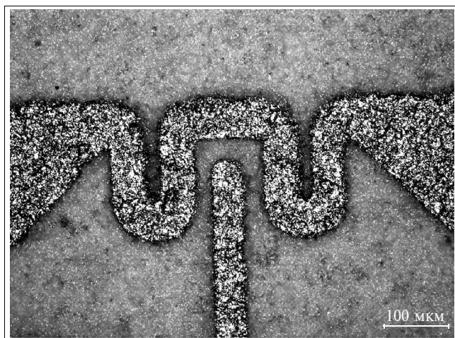
Рис. 5. Микрофотография центральной части мембраны полупроводникового сенсора с нагревателем и штыревым контактом к газочувствительному слою. Платина нанесена через прижимную маску (shadow mask). Материал мембраны — оксид алюминия
