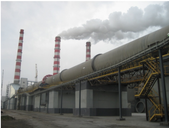
Современная вращающаяся печь по обжигу клинкера
