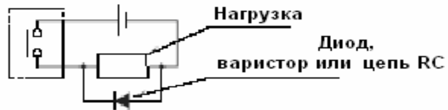
Рисунок Е.4 – Схемы защиты контактов реле сигнализации при индуктивной нагрузке
